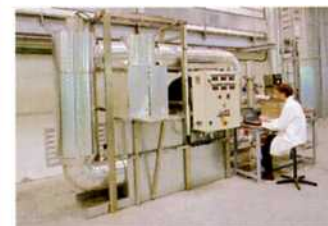
Test catalyseur oxydation COV à l'IRMA
