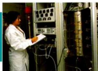
Unité de test catalytique, échelle labo (ø 1')
